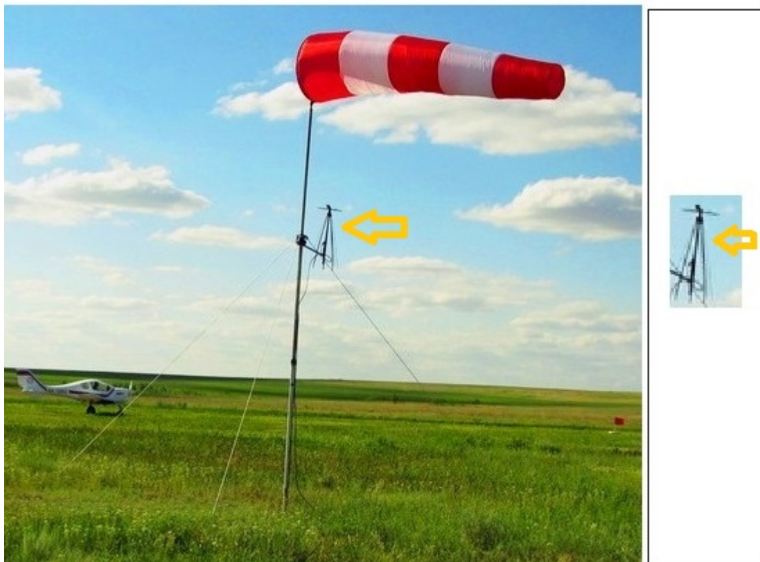
Илл.13. Мачта с ветровым конусом, растяжками и с диско-конусной УКВ радиоантенной («метёлочкой»).
